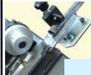
チューブ(レール)を上部に取り付けて、部品を排出 滑り落とすためのチューブ固定ユニット
