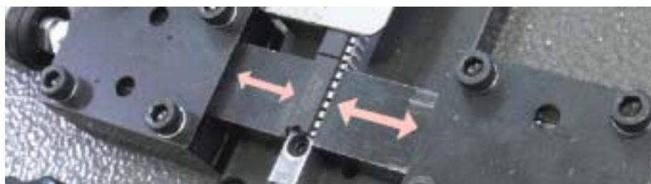
左右の矯正ブロックがリードを小刻みに押し込む事で、開いたリードを狭めてストレートに矯正します。(上は、部品押さえを外した状態の写真ですが、ブロック稼働中は常に部品押さえが被った状態)
