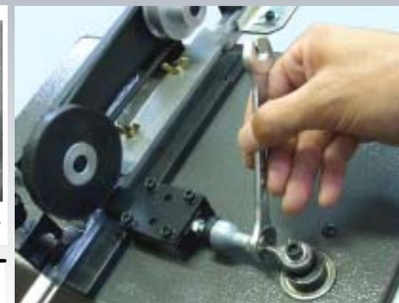
矯正ブロックの押力強度は、外側のナットを回す事で調整。
